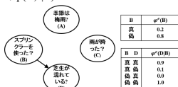
■3.14 図3.12について変換されたベイジアンネットワーク e = \{A=1, C=0\} を得た時の縮約されたベイジアンネットワーク
